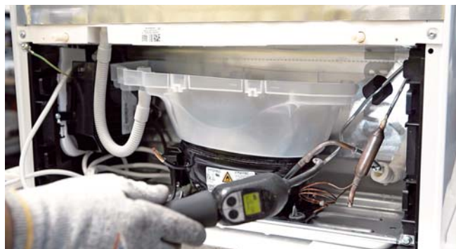
Die monotone und zeitintensive Tätigkeit, die Schnüffelsonde bis auf einen Millimeter an die Rohre zu führen, blieb bisher dem Menschen vorbehalten.
